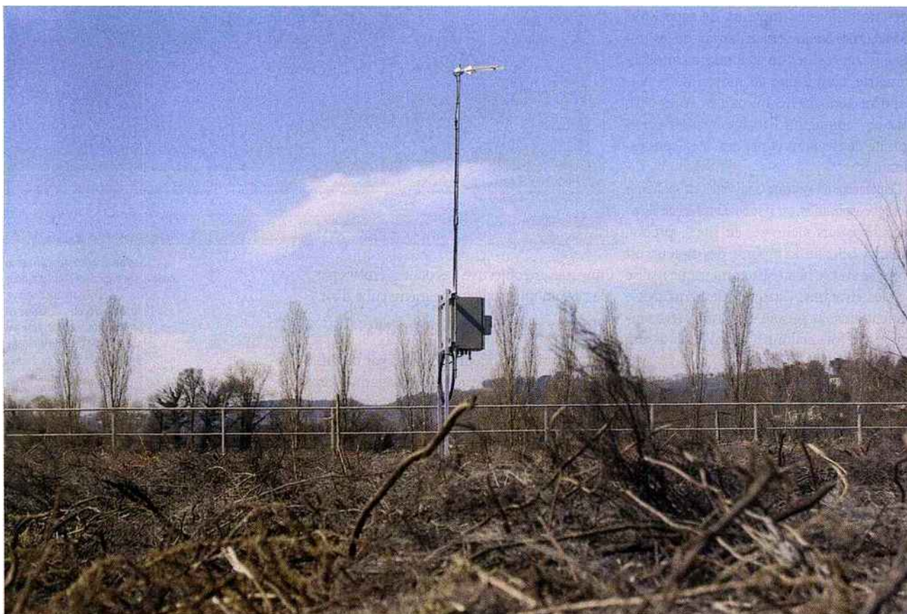
Le bio filtre constitue la principale source de nuisance olfactive du site. C'est donc là que Ferso Bio a installé le nez électronique d'Odotech. Les données sont transmises au centre de commande du site à travers un système de communication radio.
