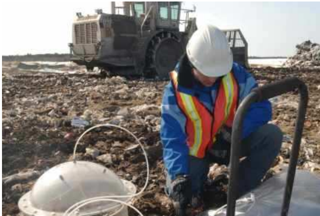
Magnun Vieiro, employé de la firme Odotech, capte ici, à l'aide d'une cloche, les odeurs qui se dégagent d'une cellule d'enfouissement à Saint-Étienne-des-Grès.
