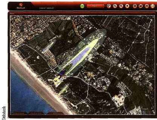
En mai 2008, le SIVOS des 60 Bornes s'est équipé du système OdoScan d'Odotech pour permettre l'évaluation en temps réel des impacts olfactifs générés par les équipements de la STEP et du réseau de collecte et le suivi en temps réel de la dispersion des odeurs.
